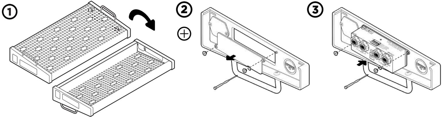
4X MOD Pro V2をテンプレートボードのモジュラーエンドパネルにマウントすることで、ボード側面から1/4インチの入出力をルーティングできるようになります。
