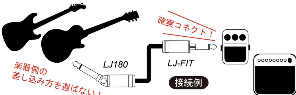
ベストな接触率を考慮して開発されたコンプレッション機能付きLJ-FITプラグは、ジャックへ確実に接続し、引っ張り強度約10%向上※。演奏中にプラグが抜けてしまうようなトラブルを防止するうえに、ジャック内部での接続性も高まって電気的な抵抗が約5%削減※され、音質改善にも効果を発揮します。※いずれも当社調べ。(実用新案登録)
